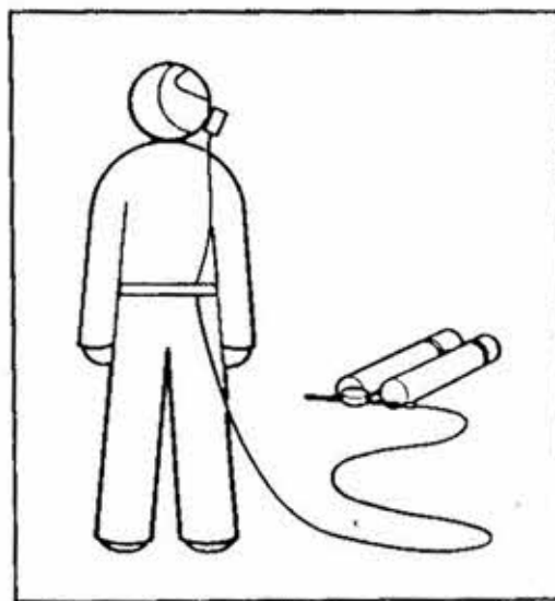
Alimentazione a distanza con dispositivo di allarme alla maschera
