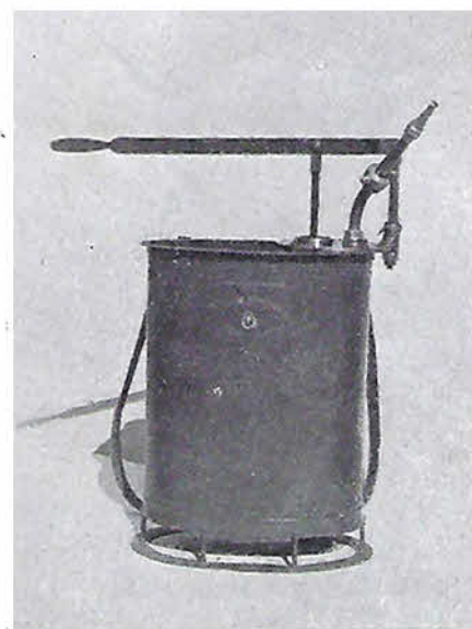
La pompa monocilindrica costruita nelle officine dell'89° Corpo V.V. F. - Venezia. Capacità del recipiente litri 30. Pressione raggiungibile 5-6 atm. Lunghezza del getto al bocchello di diametro 6 m/m ml. 12/15.
