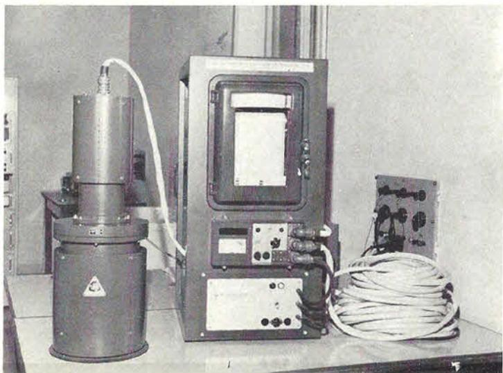
Essa consiste in un rilevante numero di ionimetri installati in località appositamente scelte in modo da costituire una fitta e continua rete di rilevamento che copre tutto il territorio nazionale.
