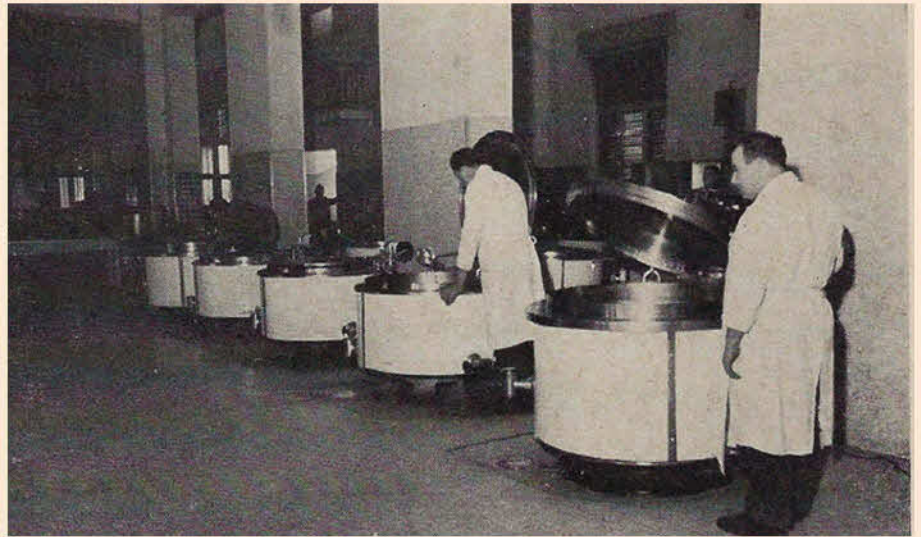
Sopra: visione parziale delle attrezzature della camera a gas per il collaudo degli autorespiratori. Annesso alla camera a gas è il laboratorio per la riparazione degli autorespiratori.
