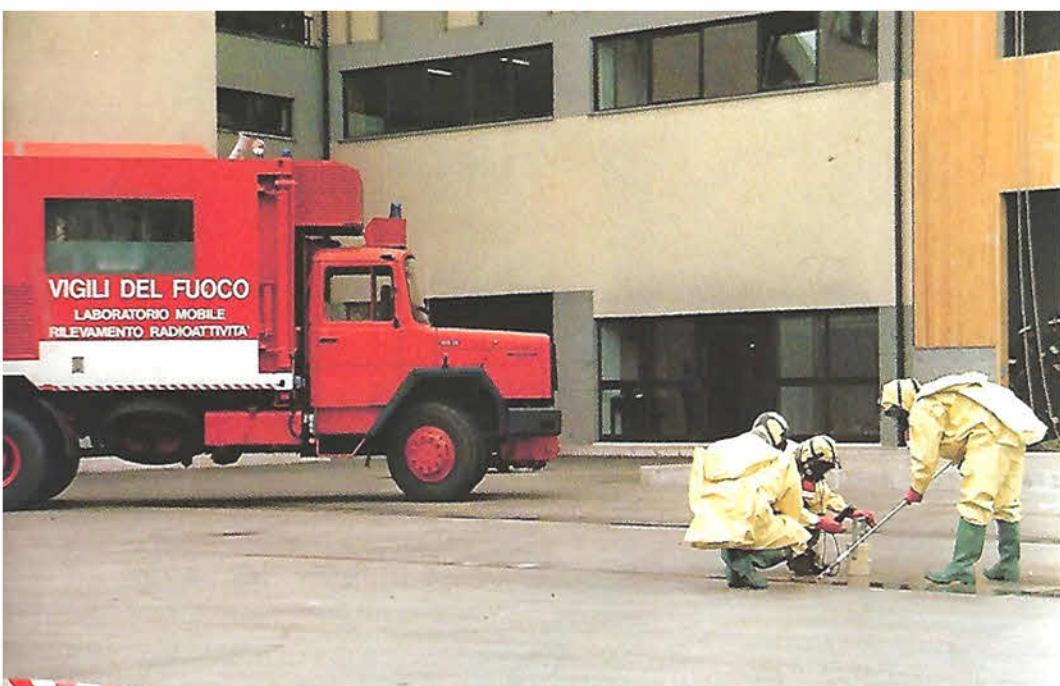
*Addestramento all'uso di apparati per il rilevamento radiometrico.*
