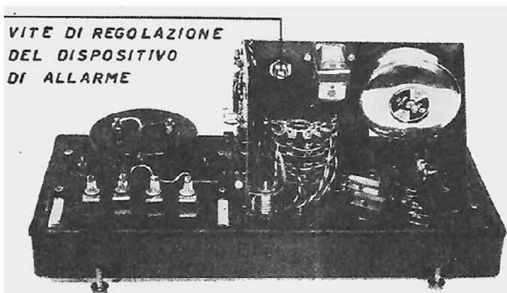
Interno dello strumento di misura CN8 con vista della vite di regolazione del dispositivo di allarme.
