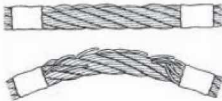
Rotture dei fili nella SEZIONE INTERNA
